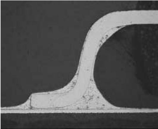
**Figure 39. NiPdAu 208 PDV TQFP,
