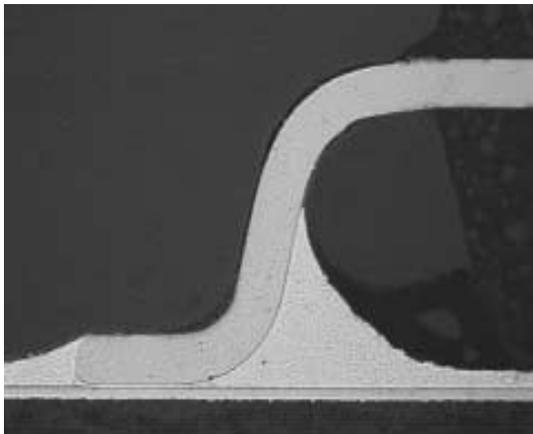
**Figure 41. NiPdAu 208 PDV TQFP,
