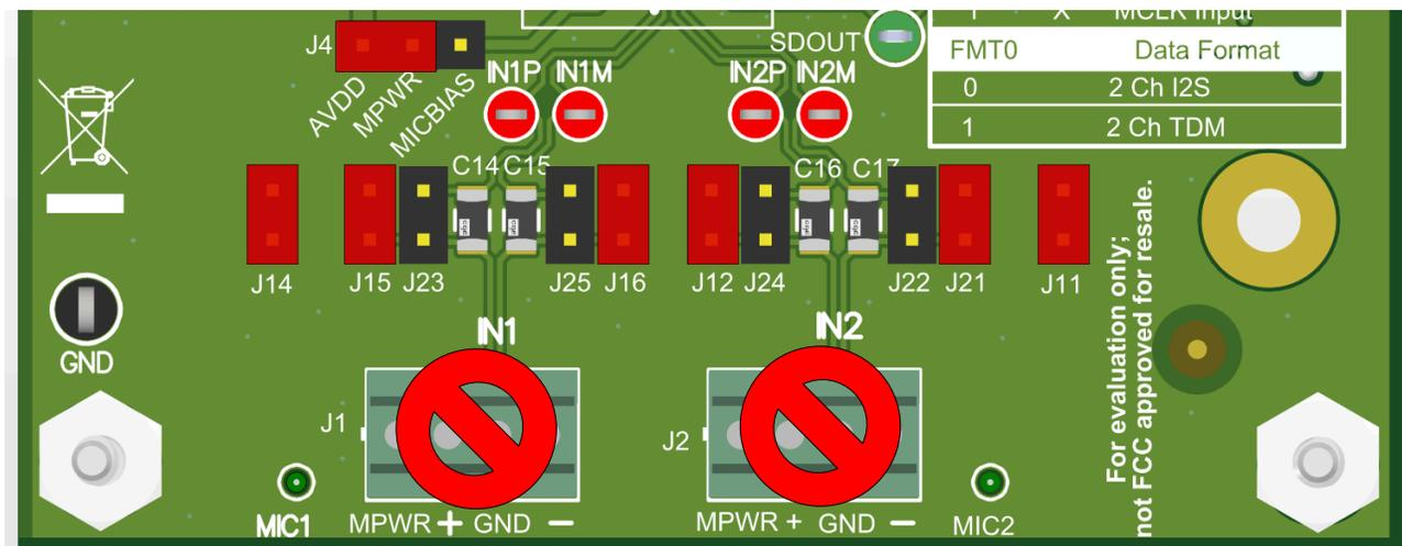
图 4-2. PCM182x/PCM182x-Q1 板载麦克风
