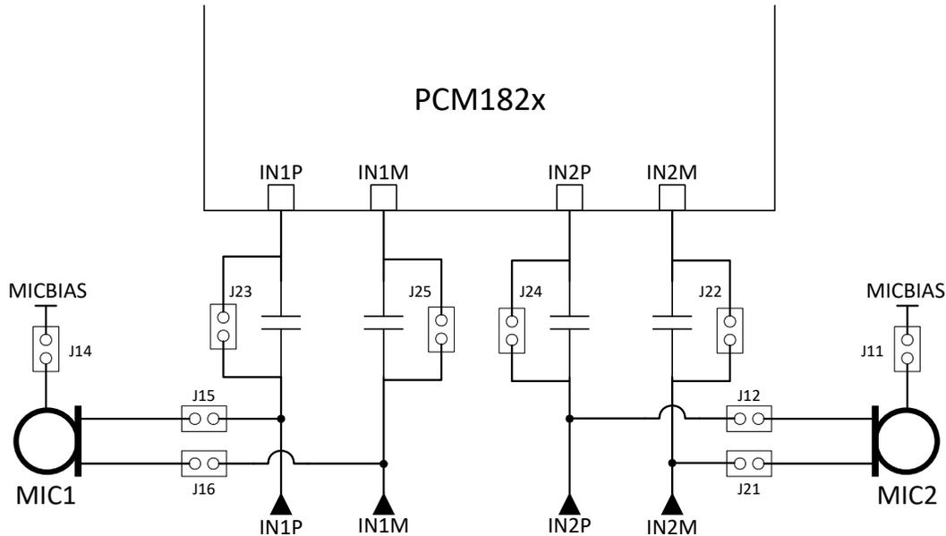
图 4-1. PCM182x/PCM182x-Q1 输入架构
