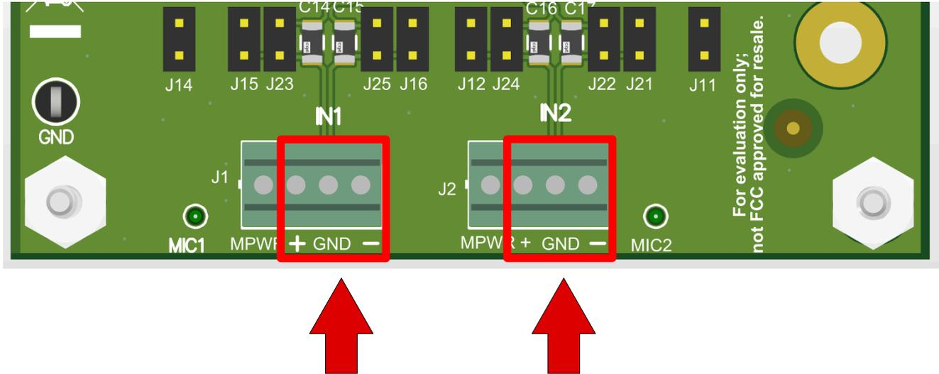
图 4-3. PCM182x/PCM182x-Q1 线路输入
